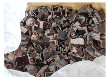
有害物質である鉛が含まれるバッテリーの破砕物
