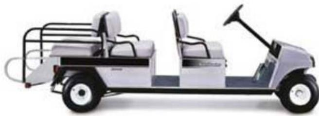
**8703.10 3. 351cc の単気筒内燃機関（11.5 馬力）を搭載した四輪車両**
