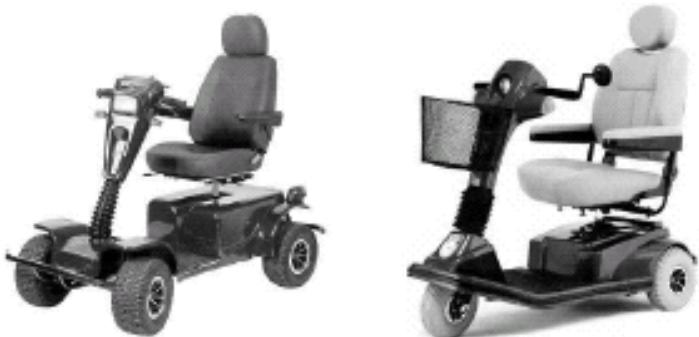
**8703.10 2. 電池式電動機（8個の6ボルト電池、3.7馬力）を搭載した四輪車両**
