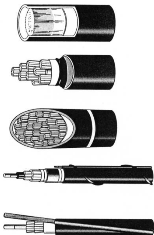
通信用の電線
