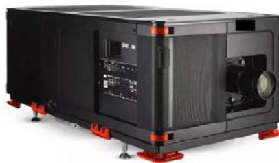
プロジェクター本体（外付けの冷却装置は写真には含まれない）
