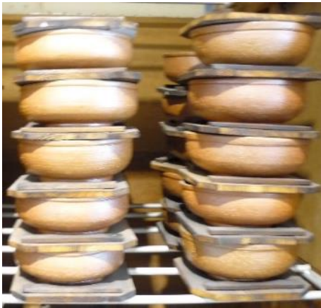
明治・大正時代に使用されていた 鋳物製の結晶皿。熱源は炭火を使用。
