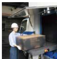
X線車による貨物検査
