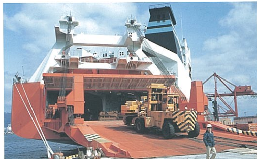
ローロー船①“BARBER TAMPA” 世界最大のRo Ro 船 (昭.51 神戸入港) バラ積貨物を船尾からフォークリフト、キャリアを使って積卸しする新しい荷役方法を持っている。
