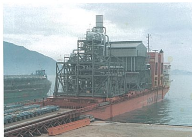
世界唯一の多目的船“Dock Express” (昭.57.1 糸崎入港) Ro Ro 及び Lo Lo のほかフロートイン・フロートアウトの荷役方式が可能である。写真は、重量1,600トンのプラントを積込んでいる。
