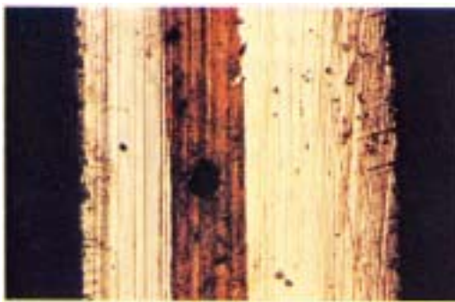
Photo. 6 レーザー光線で発光させた跡, 直径は 20 \mu である。
