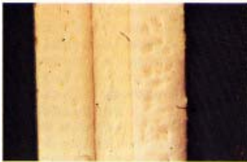
Photo. 5 高温用のバイメタル, 厚さ 0.7mm。中心に純ニッケルを用いている。
