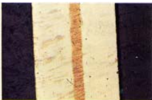
Photo. 3 高温用のバイメタル, 厚さ 0.5mm。中心に純銅を用いている。
