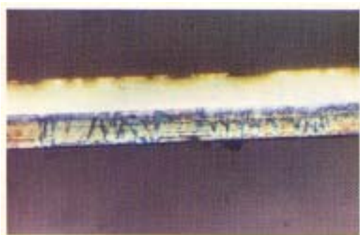
Photo. 1 一般用のバイメタル, 厚さ 0.2mm。
