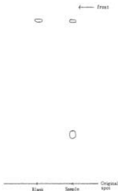
Fig. 5 Thin - layer Chromatograms of DNS - Morphine solvent system ; \text{CH}_3\text{CN} : \text{H}_2\text{O} (85 : 15V / V) detector ; UV254nm
